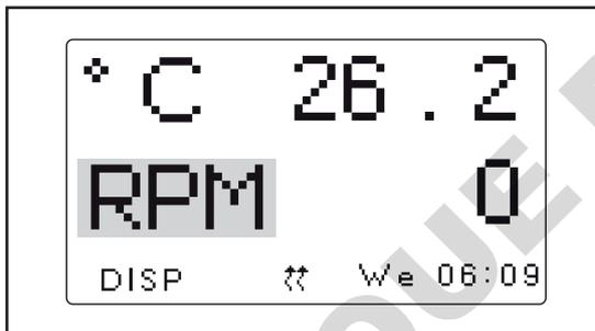
1. Tourner le **bouton de commande** pour sélectionner le paramètre que vous voulez changer. Dans cet exemple, nous allons transformer le paramètre *RPM* en *HRS*.
