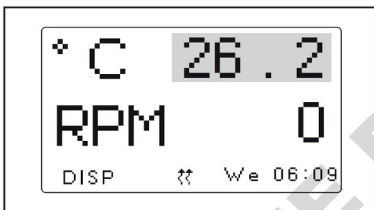
1. Utiliser le **bouton de commande** pour sélectionner la valeur mesurée (réelle) (26,2 °C sur la figure).
