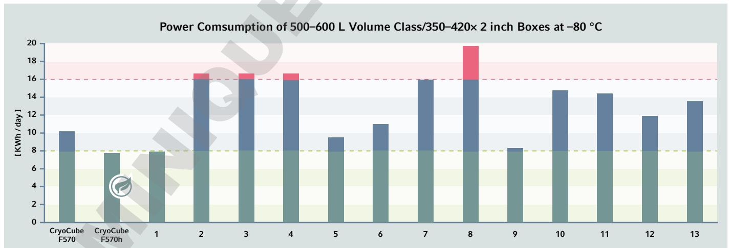
Comparaison du nombre de kilowatts heure par jour requis pour maintenir 350 à 420 boîtes de deux pouces à une température de -80 °C dans des congélateurs ayant un volume de 500 à 600 L. Le CryoCube F570h (230 V/50 Hz) peut maintenir la température de stockage avec 7,6 KWh/jour, moins de 50 % de l'énergie requise par d'autres unités.
