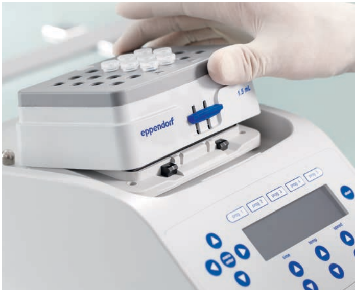
Retrait du SmartBlock de l'Eppendorf ThermoMixer® C
