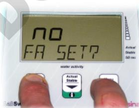
Tous les paramètres peuvent être remis en configuration usine, excepté les valeurs de calibration stockées dans la cellule de mesure CM-2.
