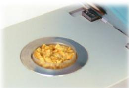
Remplissez la coupelle échantillon au 2/3 ; ne mettez jamais le produit en contact direct avec la cellule de mesure. Prenez les précautions d'usage pour la préparation de l'échantillon.
