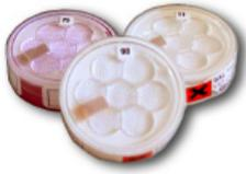
Nous recommandons de démarrer le calibrage au point 75 HR ; puis de passer au 84 % et ensuite au 58 %, 33 % et finalement au 11 %.
