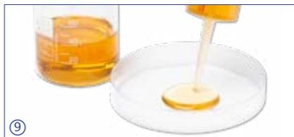
Les seringues Ecostep™ à déplacement positif évitent tout contact direct du liquide avec l'instrument. Les produits chimiques tels qu'acides, bases, solvants ou liquides moussants sont distribués facilement, de même que les réactifs à haute densité ou visqueux.
