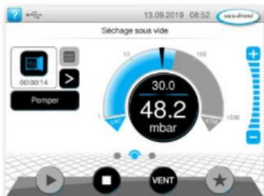
L'utilisation du VACUU-SELECT ressemble à celle d'un smartphone moderne. La navigation interactive entre les différents menus est spécialement adaptée aux applications de laboratoire. Définir les paramètres de régulation du vide justes est simple et rapide.
