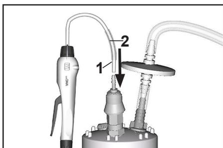
Dans un premier temps relevez le tuyau d'aspiration (1), dans un second temps coulissez la protection anti-courbure (2).
