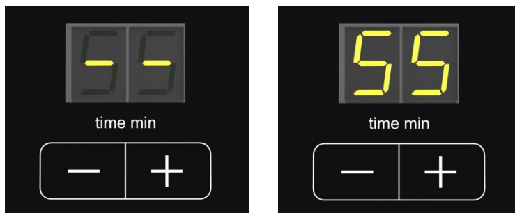
III. 14: Réglage de temps en service permanent (à gauche) ou avec une durée de processus (à droite)
