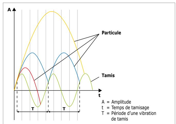
Fig. 8: Mouvement des particules par rapport au fond de collecte
