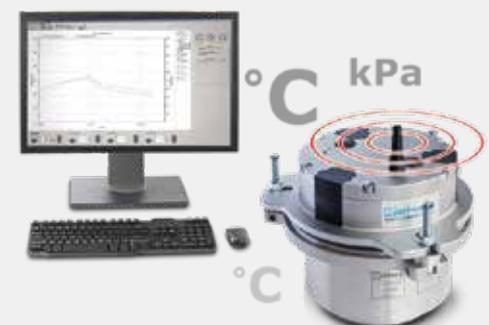
**Gammes de mesure:** Pression du gaz : jusqu'à 500 kPa, Température : 0 à 200°C
