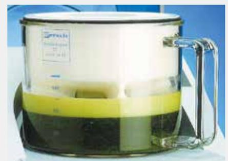
Le couvercle gravitique réduit le volume du récipient de broyage, par gravité, ce qui permet une homogénéisation complète de l'échantillon.
