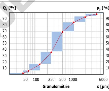
Fig. 5: Histogramme avec courbe de distribution cumulée
