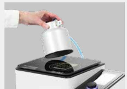
**Dispersion :** L'échantillon est distribué de manière homogène sur une lame d'objet et il est prêt pour l'analyse.
