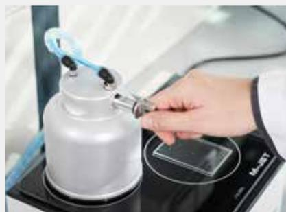
**Charger l'échantillon :** Un échantillon de poudre est placé dans la chambre de dispersion du M-Jet.
