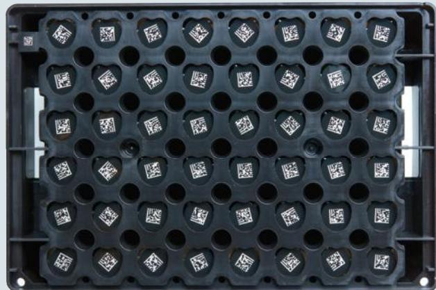
Avec l'Eppendorf RackScan et le logiciel, vous pouvez scanner plusieurs flacons en parallèle et transférer les données des échantillons vers votre logiciel de gestion des échantillons, par exemple eLABInventory ou des banques de données externes
