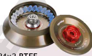
FA-24x2-PTFE Rotor anti-aérosols Eppendorf QuickLock® pour 24 tubes de 1,5/2,0 mL à vitesse max. de 21 330 × g/ 15 060 rpm ; Revêtement PTFE: haute résistance chimique et nettoyage rapide
