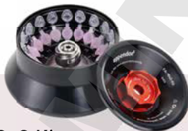
FA-18x2-Kit Rotor anti-aérosols Eppendorf QuickLock® pour 18 colonnes agitées et tubes de 1,5/2,0 mL conçu avec un bord très haut pour pouvoir centrifuger des tubes avec capuchon ouvert; à une vitesse max. de 18 565 × g/ 15 060 rpm
