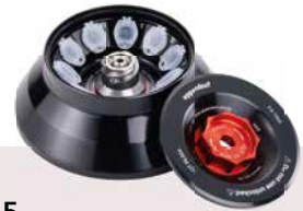
FA-10x5 Rotor anti-aérosols Eppendorf QuickLock® pour 10 tubes de 5,0 mL* à vitesse max. de 21 330 × g/ 15 060 rpm ; permet d'utiliser des adaptateurs pour maintenir des tubes de 1,5/2 ml, HLPC et Cryotubes
