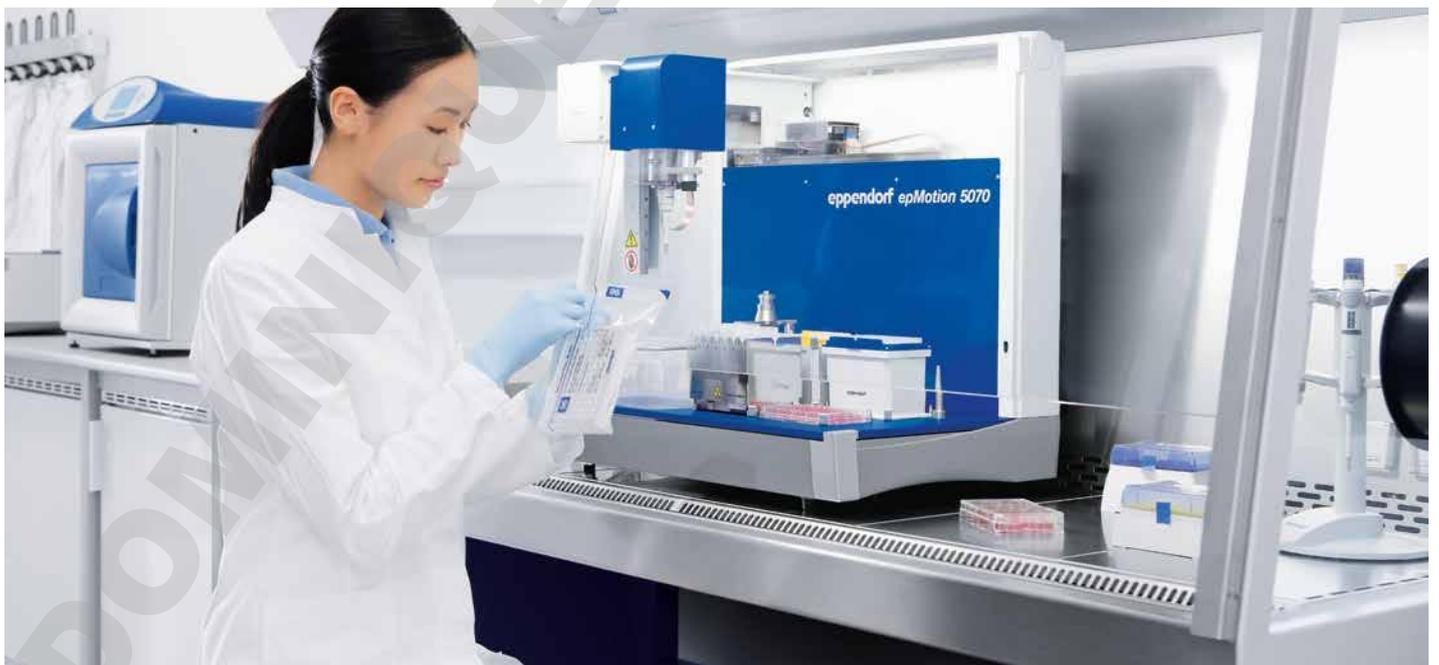
Version Compact 5070f peut être intégrée dans une paillasse à flux laminaire.
