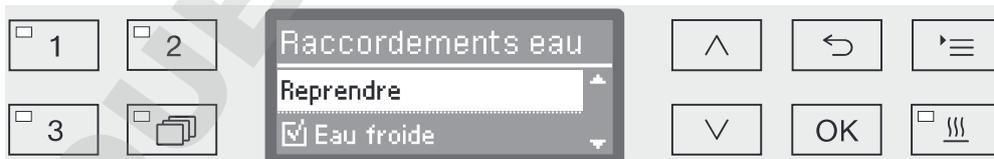
Le réglage des raccords à l'eau doit faire l'objet d'une sélection multiple. A l'écran, chaque raccordement à l'eau est suivi d'un petit carré  qui apparaît coché  en cas d'activation du raccordement correspondant. Il est possible d'activer ou de désactiver tous les raccords à l'eau.
