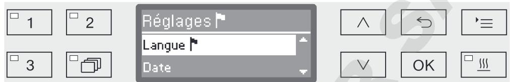
Les flèches de navigation  $\wedge$  et  $\vee$  du bandeau de commande permettent de naviguer dans le menu.
