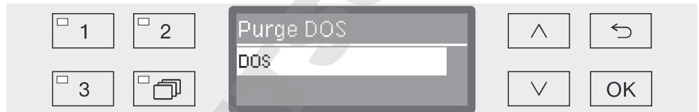
La purge automatique démarre dès qu'on sélectionne le système de dosage. Une fois démarré, le processus de purge automatique ne peut plus être interrompu.
