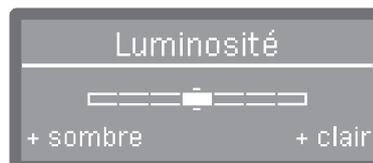
Le réglage du contraste et de la luminosité s'effectue via une barre de progression affichée à l'écran.
