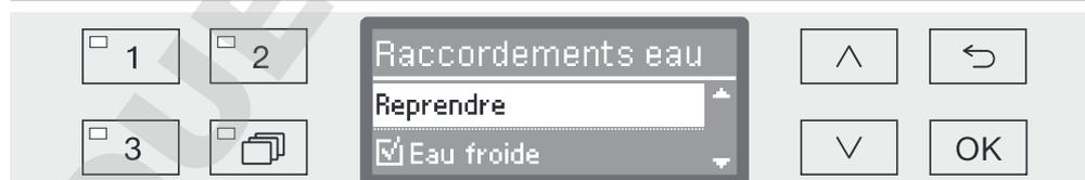
Le réglage des raccordements à l'eau doit faire l'objet d'une sélection multiple. A l'écran, chaque raccordement à l'eau est suivi d'un petit carré  qui apparaît coché  en cas d'activation du raccordement correspondant. Il est possible d'activer ou de désactiver tous les raccordements à l'eau.
