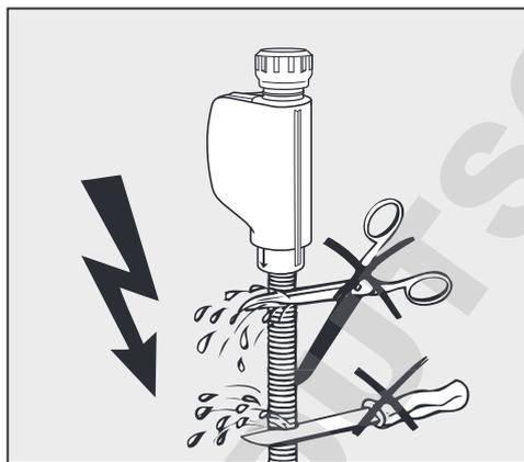
⚠ Les tuyaux d'arrivée d'eau ne doivent **pas** être ni raccourcis ni endommagés !
