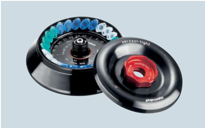
Rotor anti-aérosols pour 24 tubes 1,5/2,0 mL, vitesse max. 21 130 × g/15 000 tr/min. (FA-45-24-11 ; code 5424 702.007).
