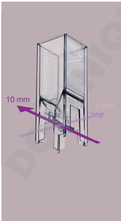
L'UVette Eppendorf est une cuvette UV/Vis brevetée\* à usage unique, constituée d'un polymère transparent et utilisable de 220 nm à 1 600 nm. Son design unique vous permet de réaliser des mesures polyvalentes selon deux longueurs de trajet optique différentes (10 mm et 2 mm).
