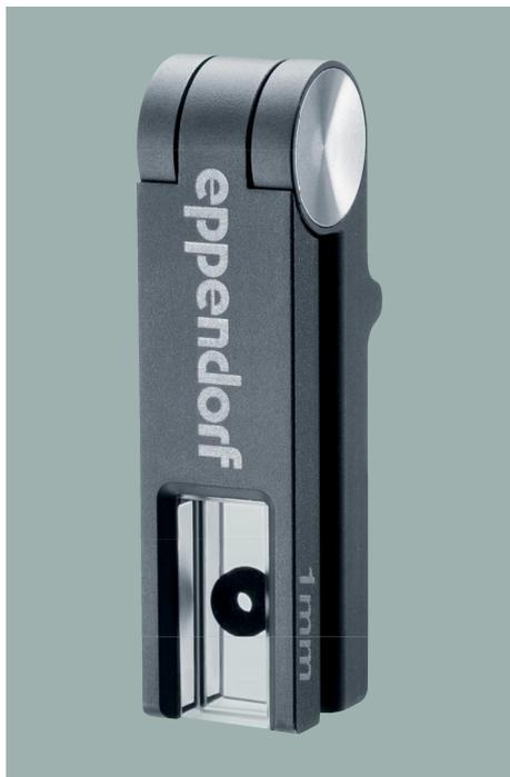
La  $\mu$ Cuvette G1.0, avec un trajet optique de seulement 1 mm, fournit un faisceau lumineux 10 fois plus court que celui des cuves standard. La  $\mu$ Cuvette G1.0 permet ainsi de mesurer de hautes concentrations d'acide nucléique et de protéines. Vous pouvez réaliser une mesure avec seulement 1,5  $\mu$ L d'échantillon. La  $\mu$ Cuvette G 1.0 étend ainsi la versatilité des domaines d'application photométrique de tous nos appareils de détection en cuves.
