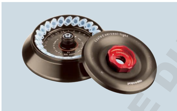
Rotor anti-aérosols pour 24 tubes 1,5/2 mL avec revêtement PTFE à haute résistance aux produits chimiques. Vitesse max. 21 130 × g/15 000 tr/min (FA-45-24-11-Special ; code 5424 700.004).
