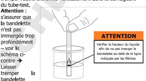
pendant 10 à 15 secondes puis la placer sur une surface PROPRE et horizontale ; ne pas toucher ou déplacer la bandelette pendant 5 à 10 minutes, le temps de la migration de l'échantillon.
