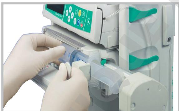
3. Refermer le verrou de seringue en maintenant la seringue de la main gauche (les ailettes doivent être positionnées à la verticale dans la fente située à gauche de la butée verte), puis refermer le couvercle. Le frein de piston avance.
