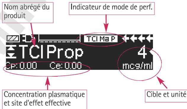
Vous pouvez naviguer jusqu'au paramètre dans l'angle inférieur gauche. Le volume restant dans la seringue dépend du débit calculé. En raison de l'algorithme AIVOC évolutif, le débit varie et le volume restant dans la seringue ne peut techniquement pas être précisément prédit.
