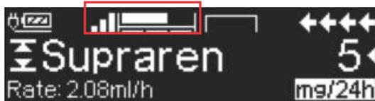
Sur l'écran principal, la ligne supérieure affiche la pression de perfusion actuelle. La ligne inférieure et les 3 traits apparaissant sous le symbole affichent les paramètres de l'alarme de pression.
