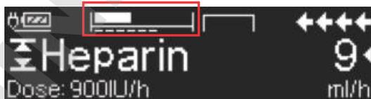
La ligne du haut correspond à la pression actuelle de perfusion. La ligne en pointillés du bas indique la consigne d'alarme de pression, actuellement de 5 sur 9, ce qui est représenté par 5 pointillés. L'illustration montre la pression actuelle d'environ 30 % du niveau de pression 5.
