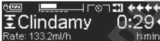
Exécuter Menu Run : Le temps est utilisé pour contrôler la thérapie. Pour cette raison, le temps restant s'affiche en gros dans le menu Exécuter. Vous pouvez naviguer jusqu'au paramètre dans l'angle inférieur gauche. Réglez sur Débit lorsque vous laissez l'appareil.
