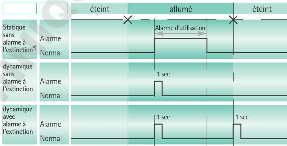
\*) en mode statique sans alarme à l'extinction, le renvoi d'alarme peut être supprimé par
