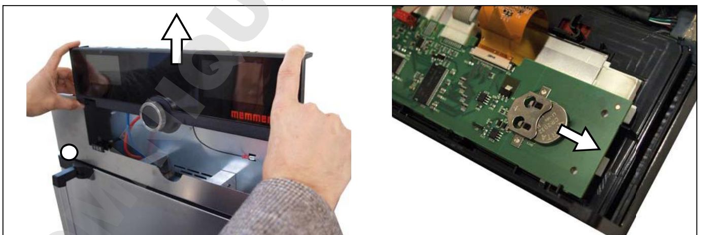
III. 32 ○ Retrait de la batterie lithium
