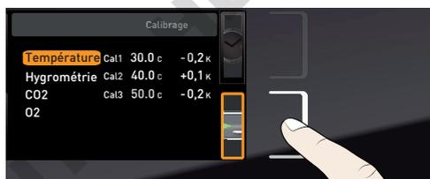
2. Tourner le bouton rotateur jusqu'à l'affichage CO<sub>2</sub> ou O<sub>2</sub>.
