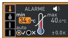
1. À l'aide du bouton rotateur, régler la valeur limite inférieure de l'alarme souhaitée, dans l'exemple à droite 35,5 °C.
