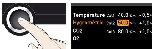
4. À l'aide du bouton rotateur, régler le point d'étalonnage Cal2 sur 60 % rh.
