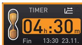
**i** L'heure est indiquée au format hh:mm (heures:minutes) jusqu'à 23 heures et 59 minutes ; au-delà de 24 heures, le format dd:hh (jours:heures) est adopté. La durée maximale d'un cycle est de 99 jours et 00 heure.
