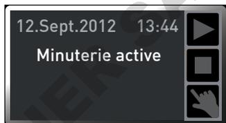
▶ Lorsque l'appareil est en mode Programmation, cela est signalé par l'affichage Minuterie active à l'écran :
