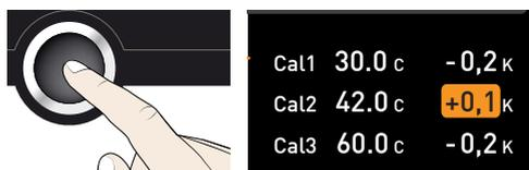
5. Régler le correctif sur 0,0 K et enregistrer ce réglage en appuyant sur la touche de validation.
