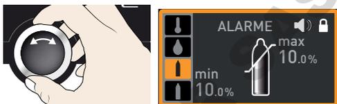
3. Accepter la sélection avec la touche de validation. La valeur limite inférieure de l'alarme est automatiquement indiquée.
