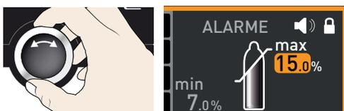
7. Pour confirmer, appuyer sur la touche de validation et pour quitter l'affichage ALARME, appuyer sur la touche d'activation sur le côté. Le dispositif de sécurité du CO<sub>2</sub> est maintenant activé.
