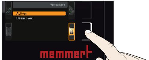
3. Appuyer sur la touche de validation pour confirmer l'activation. Les nouvelles données ID utilisateur sont transférées dans le support de données USB et sont activées. À la fin du processus d'activation, une coche apparaît devant la commande.
