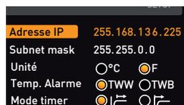
Procéder de la même façon pour le réglage du masque de sous-réseau.
