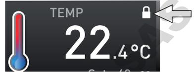
Ill. 33 Le changement de la température de l'appareil est verrouillé (exemple).
