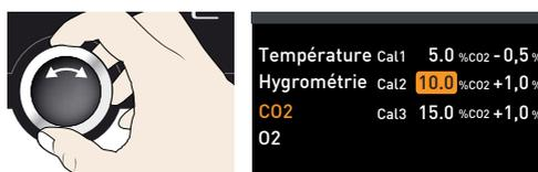
5. Appuyer sur la touche de validation pour enregistrer le réglage. La valeur corrective d'étalonnage correspondante est indiquée automatiquement.
