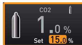
**i** Les chiffres 1 ou 2 dans le symbole de la bouteille de gaz indiquent quelle bouteille de gaz est actuellement active.
