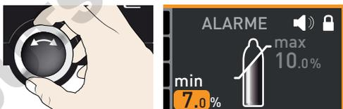
5. Accepter la sélection avec la touche de validation. La valeur limite supérieure de l'alarme est automatiquement indiquée.
