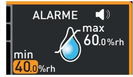
4. À l'aide du bouton rotateur, régler la valeur limite inférieure de l'alarme souhaitée, dans l'exemple à droite, 50 % rh
