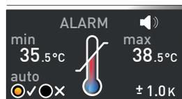
Dès que le dispositif de sécurité thermique est déclenché, cet évènement est signalé dans l'affichage de la température par la température effective indiquée en rouge et par un symbole d'alarme ▲ (Ill. 18). Le dispositif de sécurité thermique responsable du déclenchement apparaît en dessous (dans cet exemple : TWW).
