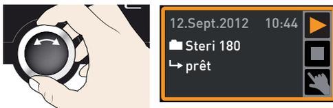
1. L'appareil ne peut exécuter à la fois que le programme sélectionné dans le mode menu et apparaissant dans la fenêtre d'affichage. Si un autre programme est prêt à être exécuté, il conviendra tout d'abord de l'activer dans le mode menu (voir la description à partir de la page 64).
