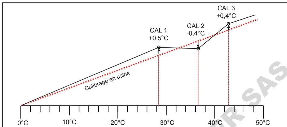
III. 30 Schéma illustrant l'étalonnage de la température
