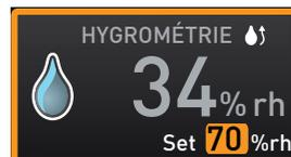
Pendant le chauffage de l'appareil, la vitesse d'approche d'hygrométrie est réglée de façon dynamique sur la valeur de consigne d'hygrométrie, et ce en fonction du point de rosée de la température intérieure.
