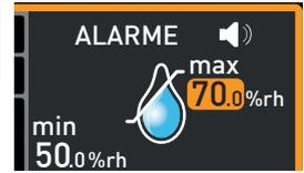
7. Pour confirmer, appuyer sur la touche de validation et pour quitter l'affichage ALARME, appuyer sur la touche d'activation sur le côté. Le dispositif de sécurité hygrométrique est maintenant activé.
