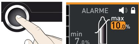
6. À l'aide du bouton rotateur, régler la valeur limite supérieure de l'alarme souhaitée, dans l'exemple à droite, 15 %.
