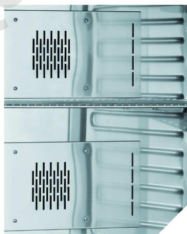
Aperçu de l'intérieur d'un incubateur Memmert: des éléments Peltier se chargent du maintien d'un excellent climat à l'intérieur du caisson.
