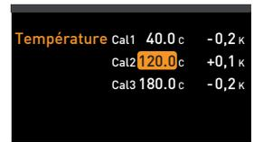
4. Appuyer sur la touche de validation pour enregistrer le réglage. La valeur corrective d'étalonnage correspondante est automatiquement indiquée.
