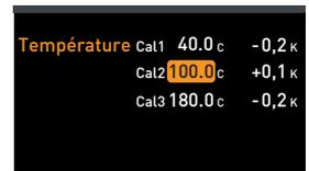
3. À l'aide du bouton rotateur, régler la température d'étalonnage Cal2 sur 120 °C.
