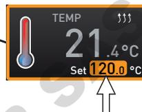
8. Attendre que l'appareil atteigne la température de consigne et affiche 120 °C. Le thermomètre étalon relève une température de 122,6 °C.
