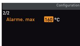
8. Appuyer sur la touche de validation pour enregistrer le réglage. Le dispositif de sécurité thermique électronique se déclenche lorsque la température effective atteint 160 °C.
