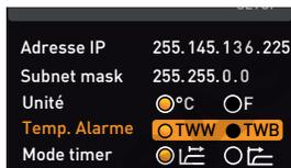
3. À l'aide du bouton rotateur, sélectionner le réglage souhaité – dans cet exemple TWB –.
