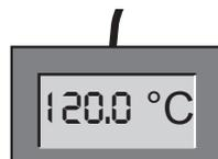
Ainsi, la valeur Cal1 permet d'ajuster de la même façon une autre température d'étalonnage inférieure à Cal2 et la valeur Cal3, une température d'étalonnage supérieure. L'écart minimum entre les valeurs Cal s'élève à 20 K pour les étuves universelles UN../UF... et à 10 K pour les étuves IN../IF...
