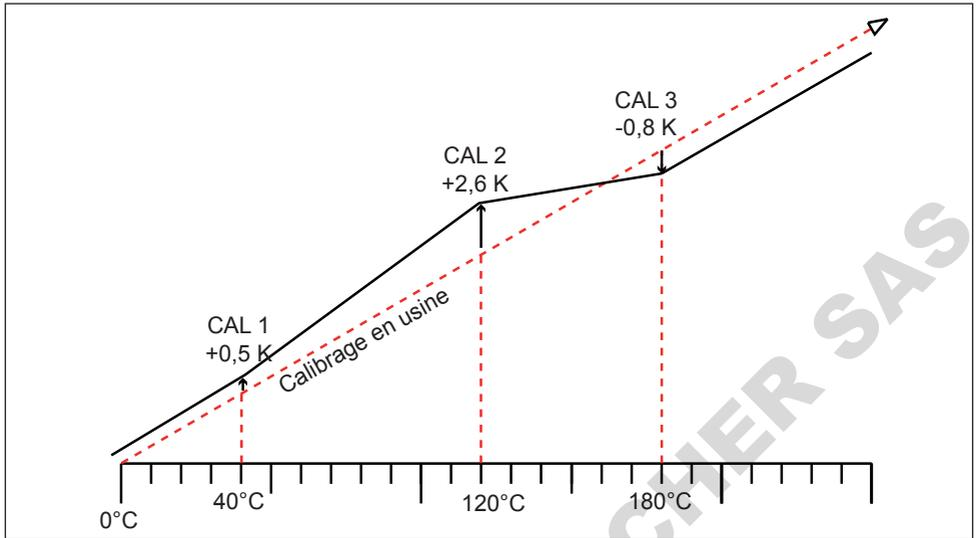
Ill. 24 Schéma illustrant l'étalonnage de la température
