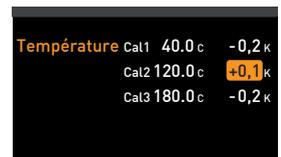
5. Régler le correctif d'étalonnage sur 0,0 K et enregistrer ce réglage en appuyant sur la touche de validation.
