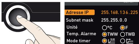
Procéder de la même façon pour le réglage du masque de sous-réseau (Subnetmask).
