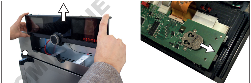
Ill. 25 Retirer la batterie lithium
