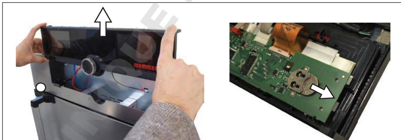
Ill. 25 Retirer la batterie lithium
