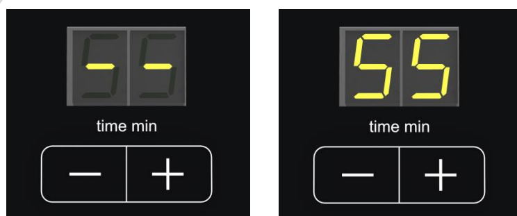
III. 14: Réglage de temps en service permanent (à gauche) ou avec une durée de processus (à droite)
