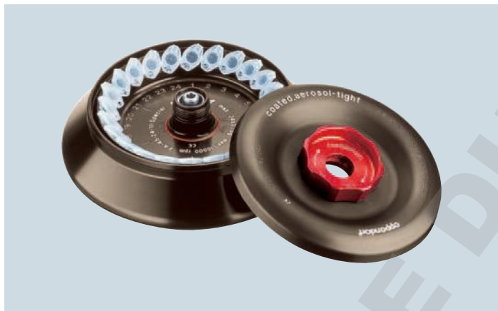
Rotor anti-aérosols pour 24 tubes 1,5/2 mL avec revêtement PTFE à haute résistance aux produits chimiques. Vitesse max. 21 130 x g/ 15 000 tr/min (FA-45-24-11-Special ; code 5424 700.004).
