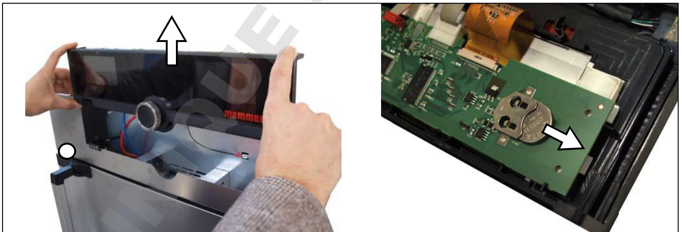
Ill. 32 Retirer la batterie lithium
