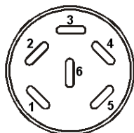
Figure 10: Occupation des pins de la douille de raccordement pour l'option Sortie analogique
