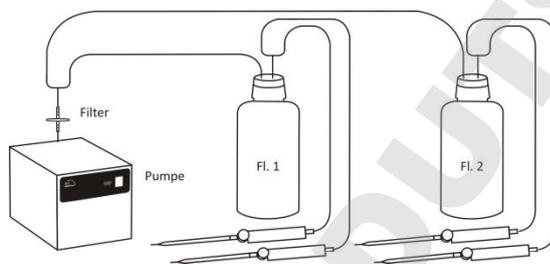
In beiden Fällen ist darauf zu achten, dass die Verbindungen an den Flaschen mit dem Y-Verteiler AY 01 von HLC by DITABIS vorgenommen werden, da dieser eine geradlinige Verbindung zu den Schnellverschlüssen der Flaschen sicherstellt (siehe Beschreibung „Zusammenbau AA 24 für zwei Arbeitsplätze“).
