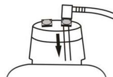
Achten Sie darauf, dass die Auffangflasche möglichst nicht ca. 75% ihres Füllvolumens überschreitet. Wird das Vakuum merklich schwächer, überprüfen Sie die Durchlässigkeit des Filters und wechseln Sie diesen ggf. aus.
