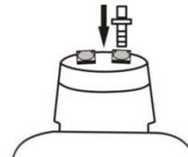
Sollte beim Absaugen Flüssigkeit in den Schlauch gelangen, der zur Pumpe führt, so kann ein ca. 5 cm langer Schlauch auf die Olive einer Schnellverschluss-Kupplung im Inneren des Deckels gesteckt werden. So vergrößert sich der Abstand zwischen Flüssigkeitseintritt und Vakuum.
