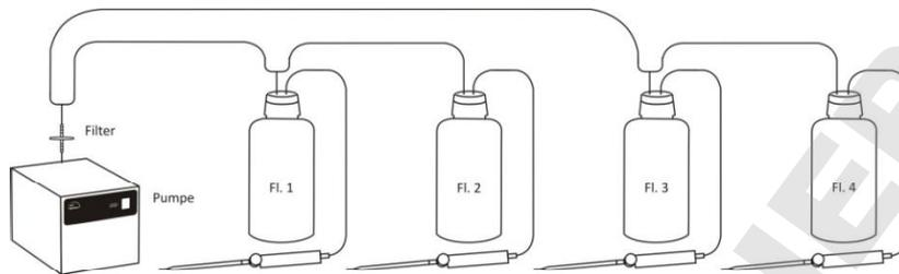
Es ist außerdem möglich zwei Flaschen mit je zwei Handgriffen an die Pumpe anzuschließen. Sie können aber auch mit Teilen jeder Variante arbeiten.
