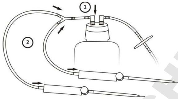
Wird mit mehr als einem Handgriff gearbeitet - sowohl bei den mehrplatzfähigen Systemen AA 02 und AA 04 als auch bei dem Zwei-Platz-System AA 24 - müssen die nicht benutzten Handgriffe immer geschlossen sein, da sich sonst kein Vakuum in der Flasche aufbauen kann.
