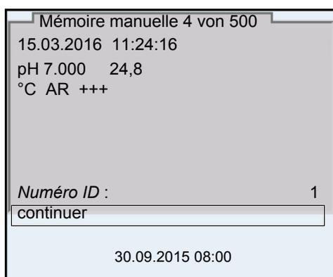
2. Avec **<▲>****<▼>** et **<ENTER>**, modifier si nécessaire le numéro d'identification (ID) et confirmer (1 ... 10000).
