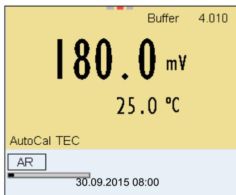
19. Attendre la fin de la mesure avec contrôle de stabilité ou appuyer sur **<ENTER>** pour mettre fin au contrôle de stabilité et reprendre la valeur de calibration.
