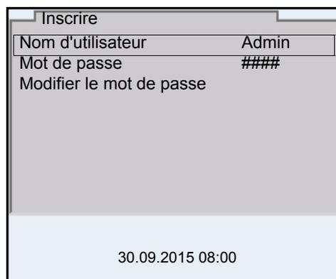
2. Avec **<▲><▼>**, sélectionner l'option *Nom d'utilisateur* et valider avec **<ENTER>**.
