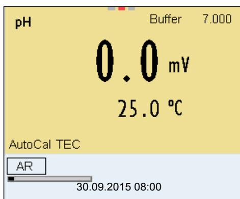
13. Attendre la fin de la mesure avec contrôle de stabilité ou appuyer sur <ENTER> pour mettre fin au contrôle de stabilité et reprendre la valeur de calibration.
