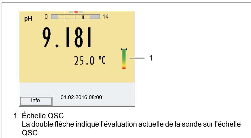
Les calibrations QSC de contrôle peuvent être effectuées à des intervalles de temps plus longs que les calibrations régulières.
