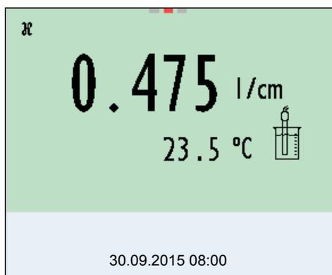
4. Immerger la sonde IDS de conductivité dans la solution d'étalon de contrôle 0,01 mol/l KCl.
