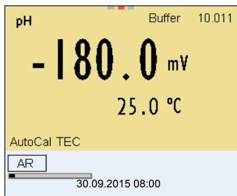
7. Attendre la fin de la mesure avec contrôle de stabilité ou reprendre la valeur de calibration avec **<ENTER>**.
