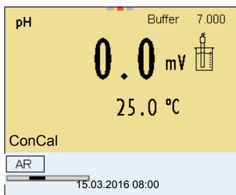
7. Attendre la fin de la mesure avec contrôle de stabilité ou appuyer sur <ENTER> pour mettre fin au contrôle de stabilité et reprendre la valeur de calibration.
