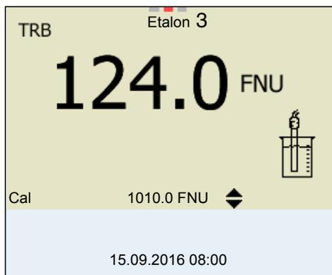
16. Appuyer sur <M> pour mettre fin à la calibration comme calibration deux points. Les nouvelles valeurs de calibration s'affichent.
