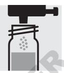
Ajouter 1 dose de PO<sub>4</sub>-2K avec le capuchon doseur bleu, fermer avec le bouchon fileté.
