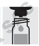
Ajouter 6 gouttes de K-1K, fermer avec le bouchon fileté et mélanger.
