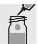
Pipetter 2,0 ml d'échantillon dans un tube avec le bouchon fileté.
