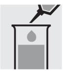
Pipetter 1,0 ml d'échantillon dans une éprouvette
