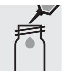
Pipetter 10 ml d'échantillon dans un tube vide (tubes vides, art. 250621).
