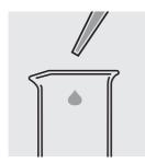
Avec une pipette, mettre 25,0 ml d'échantillon dans un bécher vide.
