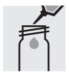
Pipetter 4,0 ml d'échantillon dans un tube vide (tubes vides, art. 250621).
