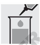
Ajouter 0,50 ml de  $H_2O_2$ -2 à la pipette et mélanger.
