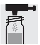
Ajouter 1 dose de **NH<sub>4</sub>-1K** avec le capuchon doseur bleu, fermer avec le bouchon fileté.
