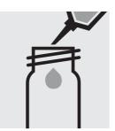
Pipetter 4,5 ml de HCHO-1 dans un tube vide (tubes vides, art. 250621).
