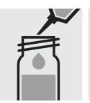
Pipetter 0,50 ml 'échantillon dans un tube à essai (provenant du test Ammonium, art 250329), fermer avec le bouchon fileté et mélanger.
