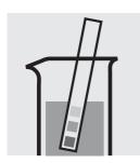
Vérifier le pH de l'échantillon. Domaine nécessaire: pH 2-11 Si nécessaire, ajuster le pH en ajoutant goutte à goutte du sodium hydroxyde en solution ou de l'acide sulfurique dilués.
