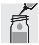
Pipetter prudemment 2,0 ml d'échantillon dans un tube à essai, fermer hermétiquement avec le bouchon fileté et mélanger vigoureusement. Attention, le tube devient brûlant.
