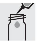
Pipetter 5,0 ml d'échantillon dans un tube vide (tubes vides, art. 250621).
