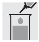
Ajouter 0,10 ml de **réactif 1** à la pipette et mélanger.
