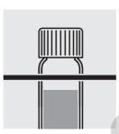
Retirer le tube du thermoréacteur et le laisser refroidir dans le support pour tubes.
