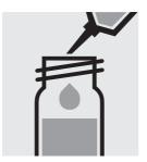
Pipetter 5,0 ml d'échantillon dans un tube à essai, ne pas mélanger.
