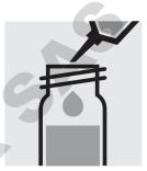
Ajouter 2,0 ml de mélange échantillon – réactif à la pipette, fermer avec le bouchon fileté et mélanger.
