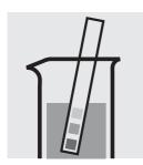
Vérifier le pH de l'échantillon. Domaine nécessaire: pH 1–7 Si nécessaire, ajuster le pH en ajoutant goutte à goutte du sodium hydroxyde en solution ou de l'acide sulfurique dilués.
