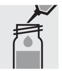
Ajouter immédiatement 1,5 ml de **NO<sub>3</sub>-2** à la pipette, fermer avec le bouchon fileté.
