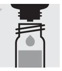
Ajouter 5 gouttes **AOX-4**, boucher avec le bouchon fileté et mélanger. Faire décanter le charbon actif. solution surnageante: **échantillon préparé.**
