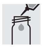
Pipetter 10 ml d'echantillon dans un tube.
