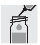
Ajouter 5,0 ml de **toluol pour analyses** à la pipette. Fermer avec le bouchon fileté.
