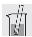
Vérifier le pH de l'échantillon. Domaine nécessaire: pH 2-7 Si nécessaire, ajuster le pH en ajoutant goutte à goutte du sodium hydroxyde en solution ou de l'acide sulfurique dilués.
