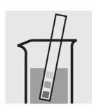
Vérifier le pH de l'échantillon. Domaine nécessaire: pH 1–12 Si nécessaire, ajuster le pH en ajoutant goutte à goutte de la solution ammoniacale ou de l'acide nitrique dilués.
