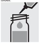
Ajouter 5,0 ml d'alcool isoamylique pour analyses à la pipette. Fermer avec le bouchon fileté.
