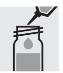
Ajouter 1,0 ml d'échantillon à la pipette fermer avec le bouchon fileté et mélanger.
