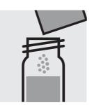
Ajouter 1 sachet de poudre de Oxyscav 1 et tube pour dissoudre la fermer avec le bouchon fileté.
