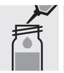
Ajouter 1,5 ml d'échantillon à la pipette lentement, fermer avec le bouchon fileté et mélanger brèvement. Attention, le tube devient brûlant.
