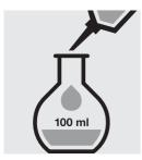
Pipetter 25 ml d'échantillon dans un ballon jaugé de 100 ml, remplir d'eau distillée jusqu'au trait et bien mélanger.
