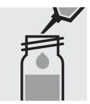
Ajouter 1,0 ml de NO<sub>3</sub>-1K à la pipette, fermer avec le bouchon fileté et mélanger.
