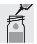
Ajouter 1,0 ml de réactif 1 à la pipette, fermer avec le bouchon fileté et mélanger.
