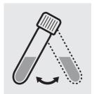
En agitant, mettre le sédiment en suspension dans le tube.
