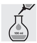
Pipetter 5,0 ml d'échantillon dans un ballon jaugé de 100 ml, remplir d'eau distillée jusqu'au trait et bien mélanger.
