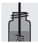
Broyer le filtre à l'aide d'un homogénéisateur
