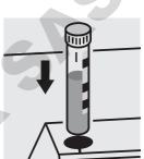
Placer le tube dans le compartiment, faire coïncider le trait du tube sur celui du photomètre. = Résultat A
