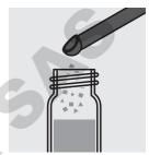
Ajouter 1 microcuiller bleue (pleine à ras) de SO<sub>4</sub>-2 et fermer le tube avec le couvercle fileté.
