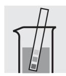
Vérifier le pH de l'échantillon. Domaine nécessaire: pH 0–10 Si nécessaire, ajuster le pH en ajoutant goutte à goutte de l'acide sulfurique dilué.
