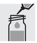
Ajouter 0,50 ml d'échantillon à la pipette, fermer avec le bouchon fileté et mélanger.
