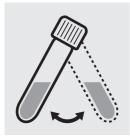
Agiter légèrement le tube avant la mesure.
