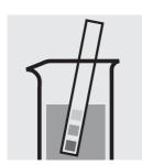
Vérifier le pH de l'échantillon. Domaine nécessaire: pH 2-5 Si nécessaire, ajuster le pH en ajoutant goutte à goutte du sodium hydroxyde en solution ou de l'acide sulfurique dilués.
