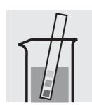
Vérifier le pH de l'échantillon. Domaine nécessaire: pH <3 Si nécessaire, ajuster le pH en ajoutant goutte à goutte de l'acide sulfurique dilué.
