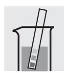
Vérifier le pH de l'échantillon. Domaine nécessaire: pH 4–10 Si nécessaire, ajuster le pH en ajoutant goutte à goutte du sodium hydroxyde en solution ou de l'acide sulfurique dilués.
