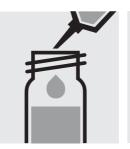
Ajouter 5,0 ml d'échantillon à la pipette, fermer avec le bouchon fileté et mélanger.
