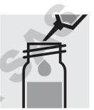
Ajouter 0,20 ml de réactif 2 à la pipette, fermer avec le bouchon fileté et mélanger.
