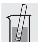
Vérifier le pH de l'échantillon. Domaine nécessaire: pH 0 – 10 Si nécessaire, ajuster le pH en ajoutant goutte à goutte de l'acide sulfurique dilué.
