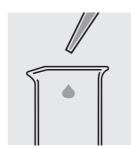
Avec une pipette, mettre 10,0 ml d'échantillon dans un bécher vide.
