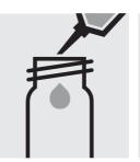
Pipetter 4,0 ml de **AC-1** dans un tube (provenant du test capacité pour acides, art 252087).
