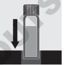
Mettre le tube dans le porte-tube du photomètre et lancer la mesure.
