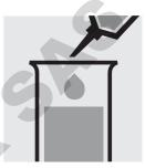
Pipetter 10 ml d'échantillon préparé dans une éprouvette.
