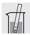
Vérifier le pH de l'échantillon. Domaine nécessaire: pH 3-8 Si nécessaire, ajuster le pH en ajoutant goutte à goutte du sodium hydroxyde en solution ou de l'acide sulfurique dilués.
