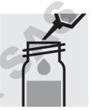
Ajouter 3,0 ml d'échantillon à la pipette, fermer avec le bouchon fileté et mélanger. Attention, le tube devient brûlant.
