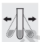
Agiter vigoureusement l'éprouvette pour dissoudre la substance solide.
