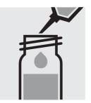
Ajouter 1,0 ml de B-1 à la pipette, fermer avec le bouchon fileté et mélanger.
