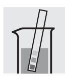
Vérifier le pH de l'échantillon. Domaine nécessaire: pH 4–13 Si nécessaire, ajuster le pH en ajoutant goutte à goutte du sodium hydroxyde en solution ou de l'acide sulfurique dilués.
