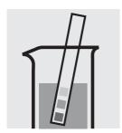
Vérifier le pH de l'échantillon. Domaine nécessaire: pH 3 - 8 Si nécessaire, ajuster le pH en ajoutant goutte à goutte du sodium hydroxyde en solution diluée ou de l'acide sulfurique dilué.
