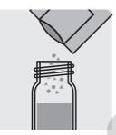
Ajouter le contenu d'un sachet de poudre de VARIO Ascorbic Acide et fermer le tube avec le couvercle fileté.
