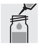
Pipetter 0,50 ml de **Na-1K** dans un tube à essai et mélanger.
