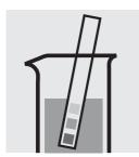
Vérifier le pH de l'échantillon. Domaine nécessaire: pH 3-9 Si nécessaire, ajuster le pH en ajoutant goutte à goutte du sodium hydroxyde en solution ou de l'acide sulfurique dilués.
