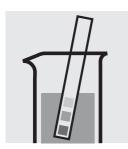
Vérifier le pH de l'échantillon. Domaine nécessaire: pH 2 – 12
