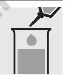
Pipetter 5,0 ml d'échantillon dans une éprouvette.
