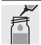
Pipetter 3,0 ml d'échantillon préparé par agitation dans un tube à essai.
