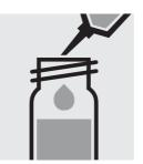
Ajouter 5,0 ml d'acide sulfurique 40 %. Fermer avec le bouchon fileté et mélanger.
