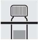
Replacer le tube dans le support et laisser refroidir jusqu'à température ambiante (très important).
