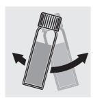
Mettre le dépôt en suspension dans le tube de test en agitant le tube.
