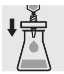
Filtrer la solution à doser sur une membrane filtrante taille de pores 0,45 µm.
