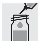
Ajouter à la pipette 6,0 ml de Au-4 et fermer pendant 1 minute. avec le bouchon fileté.
