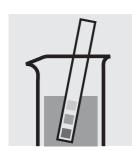
Vérifier le pH de l'échantillon. Domaine nécessaire: pH 0-13
