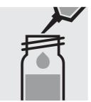
Pipetter 5,0 ml d'échantillon dans un tube à essai, fermer avec le bouchon fileté et mélanger.
