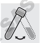
Agiter le tube avant la mesure.
