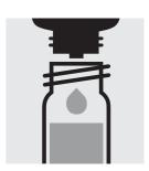
Ajouter 15 gouttes de B-5, fermer avec le bouchon fileté et mélanger.
