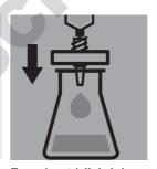
En opérant à **l'abri de la lumière**, filtrer l'extrait par un filtre adéquatec un peu d'éthanol.
