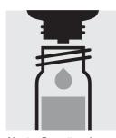
Ajouter 5 gouttes de P-2K, fermer avec le bouchon fileté et mélanger.
