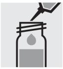
Pipetter 10 ml d'échantillon dans un tube à essai, fermer avec le bouchon fileté et mélanger.
