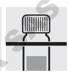
Retirer le tube du thermoréacteur, le laisser refroidir à température ambiante dans un support d'éprouvettes.
