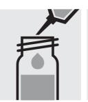
Pipetter 0,50 ml d'échantillon dans un tube à essai, fermer avec le bouchon fileté et mé-langer.
