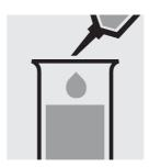
Ajouter 5,0 ml d'eau distillée et 0,50 ml d'échantillon à la pipette et mélanger.
