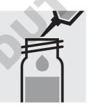
Pipetter 10 ml d'échantillon dans un tube à essai, fermer avec le bouchon fileté et mélanger.
