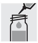
Pipetter prudemment 2,0 ml d'échantillon dans un tube à essai, fermer hermétiquement avec le bouchon fileté et mélanger vigoureusement. Attention, le tube devient brûlant.
