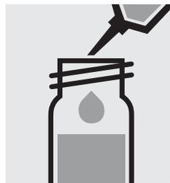
Ajouter 1,0 ml de **H-1K** à la pipette, fermer avec le bouchon fileté et mélanger.
