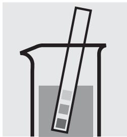
Vérifier le pH de l'échantillon. Domaine nécessaire: pH 1–12
