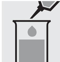
Pipetter 5,0 ml d'échantillon dans une éprouvette.
