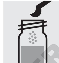
Ajouter 1 microcuiller verte arasée de **Cd-2K**, fermer avec le bouchon fileté.
