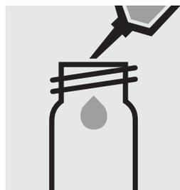
Pipetter 4,5 ml de **HCHO-1** dans un tube vide (tubes vides, art. 250621).
