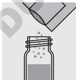
Ajouter le contenu d'un sachet de poudre **VARIO Silica LR Amino Acid F F10**, fermer le tube au moyen du couvercle fileté et mélanger.
