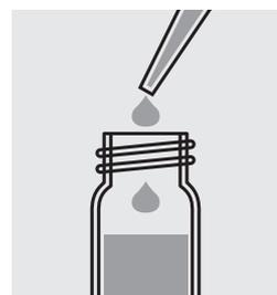
Pipeter 2,0 ml d'échantillon préparé dans un tube à réaction **Total Nitrogen Acid HR (Reagent C)** et fermer le tube avec le couvercle fileté.
