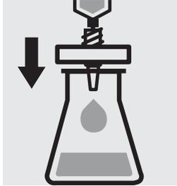
Filtrer la solution à doser sur une membrane filtrante taille de pores 0,45  $\mu m$ .
