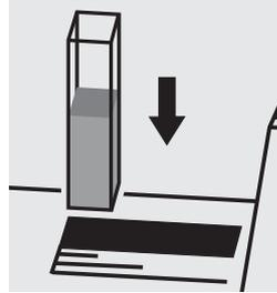
Placer la cuve dans le compartiment. Sélectionner la méthode n° 303.
