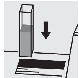
Placer la cuve dans le compartiment. Sélectionner la méthode **Palladium** dans le menu (méthode n° 133).
