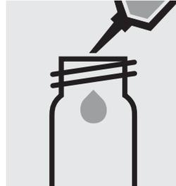
Pipetter 5,0 ml d'échantillon dans un tube à essai, fermer avec le bouchon fileté.
