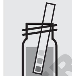
Vérifier le pH de l'échantillon. Résultat nécessaire: pH 3,0. Si nécessaire, ajuster le pH en ajoutant goutte à goutte du sodium hydroxyde en solution ou de l'acide sulfurique dilués.
