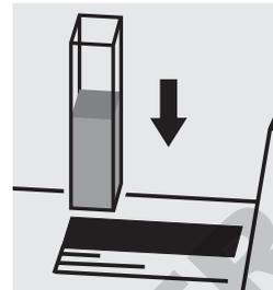
Placer la cuve dans le compartiment. Sélectionner la méthode **Bain Ni** dans le menu (méthode n° 57).
