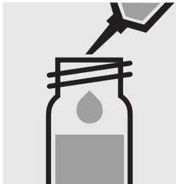
Ajouter 5,0 ml d'**alcool isoamylique pour analyses** à la pipette. Fermer avec le bouchon fileté.
