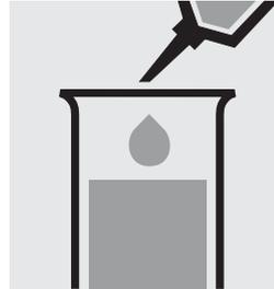
Pipetter 8,0 ml d'échantillon dans une éprouvette.
