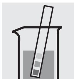
Vérifier le pH de l'échantillon. Domaine nécessaire: pH 4–8. Si nécessaire, ajuster le pH en ajoutant goutte à goutte du sodium hydroxyde en solution ou de l'acide sulfurique dilués.
