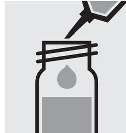
Ajouter 1,0 ml de **NO<sub>3</sub>-1K** à la pipette, fermer avec le bouchon fileté et mélanger. **Attention, le tube devient brûlant.**
