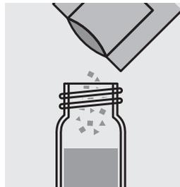
Ajouter le contenu d'un sachet de poudre de **VARIO Molybdenum HR3 F10** et fermer le tube avec le couvercle fileté.
