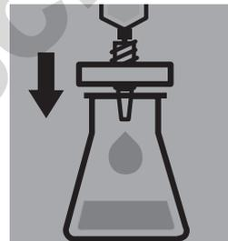
En opérant à l'abri de la lumière, filtrer l'extrait par un filtre adéquat avec un peu d'éthanol.
