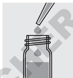
Ajouter avec une pipette 2,0 ml de **VARIO Sodium hydroxide 1,00 N**, fermer le tube au moyen du couvercle fileté et mélanger.
