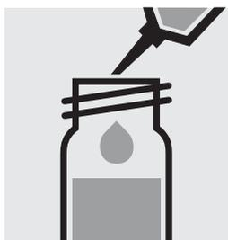
Ajouter 1,0 ml de **Mg-1K** à la pipette, fermer avec le bouchon fileté et mélanger.
