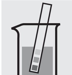
Vérifier le pH de l'échantillon. Domaine nécessaire: pH 3 – 8
