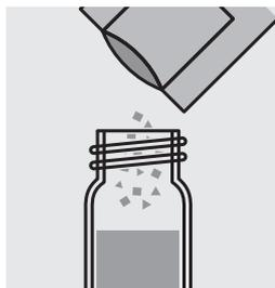
Ajouter le contenu d'un sachet de poudre de **VARIO Nitri 3 F10** et fermer le tube avec le couvercle fileté.
