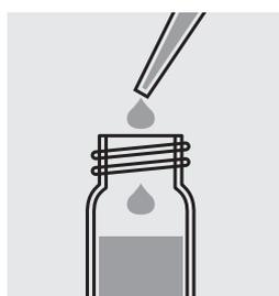
Pipeter 2,0 ml d'échantillon dans un tube de réaction.
