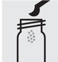
Ajouter 2 microcuillers bleues arasées de **NO<sub>2</sub>-1K** dans un tube à essai.
