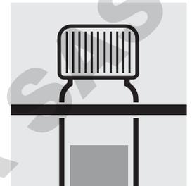
Retirer le tube du thermoréacteur, le laisser refroidir jusqu'à température ambiante dans un support d'éprouvettes: **échantillon préparé**.
