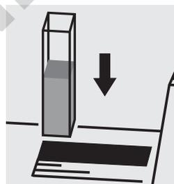
Placer la cuve dans le compartiment. Sélectionner la méthode **Platine** dans le menu (méthode n° 134).
