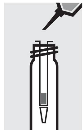
Séparer la colonne du réservoir, Faire couler à 3 reprises 1 ml à chaque fois de réactif **AOX-3** au travers de la colonne. Jeter la solution de lavage.
