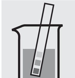
Vérifier le pH de l'échantillon. Domaine nécessaire: pH 4,5–8,0. Si nécessaire, ajuster le pH en ajoutant goutte à goutte du sodium hydroxyde en solution ou de l'acide sulfurique dilués.
