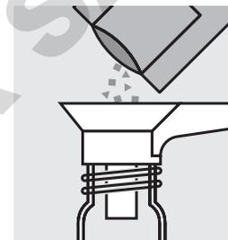
Ajouter le contenu d'un sachet de poudre de **VARIO Total Nitrogen Reagent A**, fermer le tube avec le couvercle fileté et mélanger pendant au moins 15 s.
