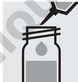
Ajouter à la pipette 6,0 ml de **B-6**, fermer avec le bouchon fileté et mélanger.
