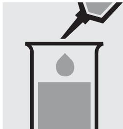
Pipetter 5,0 ml d'échantillon dans une éprouvette.
