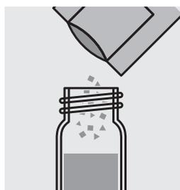
Ajouter le contenu d'un sachet de poudre de **Chlore Total-DPD F10** et fermer le tube avec le couvercle fileté.
