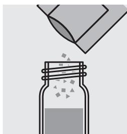
Ajouter le contenu d'un sachet de poudre de **VARIO Silica HR Molybdate F25** et fermer le tube avec le couvercle fileté.
