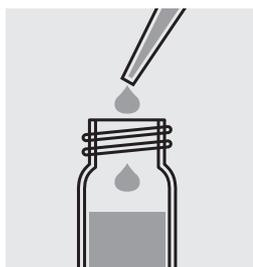
Avec une pipette, ajouter 2,0 ml d'échantillon, fermer le tube avec le couvercle fileté et mélanger vigoureusement pendant au moins 30 s. Il se peut, éventuellement, qu'une petite quantité de matière solide ne soit pas dissoute.
