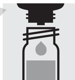
Ajouter 5 gouttes **AOX-4**, boucher avec le bouchon fileté et mélanger. Faire décanté le charbon actif. solution surnageante: **échantillon préparé.**
