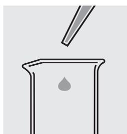
Avec une pipette, mettre 10,0 ml d'échantillon dans un bécher vide.
