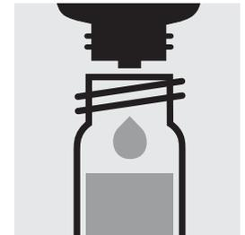
Ajouter 1 goutte de **Ag-4**, fermer avec le bouchon fileté et mélanger.
