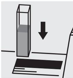
Placer la cuve dans le compartiment. Sélectionner la méthode **Bain Cr** dans le menu (méthode n° 20).
