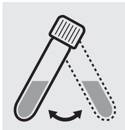
Agiter légèrement le tube avant la mesure.
