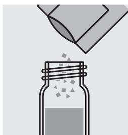
Ajouter le contenu d'un sachet de poudre de **VARIO Phosphate RGT F10** et fermer le tube avec le couvercle fileté.
