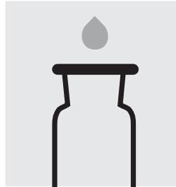
Remplir jusqu'au trop-plein 2 flacons à réaction de l'oxygène avec l'**échantillon préparé** et 2 perles de verre. Boucher sans bulles d'air avec le bouchon en verre biseauté.
