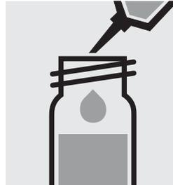
Ajouter 8,0 ml d'échantillon à la pipette dans un tube, fermer avec le bouchon fileté.
