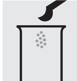
Verser 1 microcuiller grise arasée de **Cr-1** dans une éprouvette sèche.
