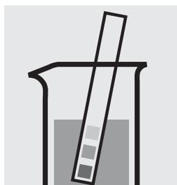
Vérifier le pH de l'échantillon. Domaine nécessaire: pH 2–11. Si nécessaire, ajuster le pH en ajoutant goutte à goutte du sodium hydroxyde en solution ou de l'acide sulfurique dilués.
