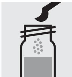
Ajouter 2 microcuillères grises arasées de  $\text{NO}_3\text{-3}$  et fermer avec le bouchon fileté.
