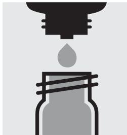
Ajouter 5 gouttes de O<sub>2</sub>-2K, fermer avec le bouchon fileté et agiter pendant 10 secondes.
