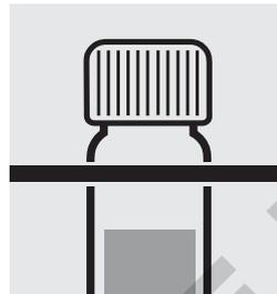
Retirer le tube du thermoréacteur, le laisser refroidir jusqu'à température ambiante dans un support d'éprouvettes.
