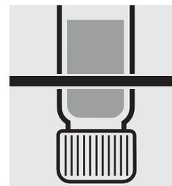
Retirer le tube du thermoréacteur, le laisser refroidir **placé la tête en bas** 1 heure.
