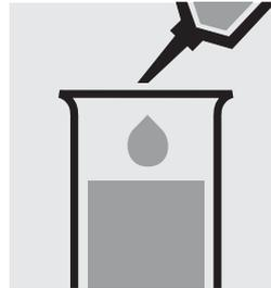
Pipetter 5,0 ml d'échantillon dans une éprouvette.
