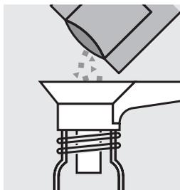
Verser le contenu d'un sachet de poudre de **Total Nitrogen Persulfate RGT** dans un tube à dissolution **Total Nitrogen Hydroxide HR Tube**.
