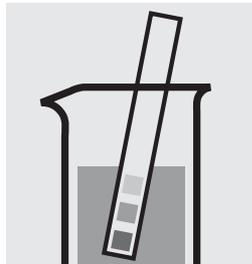
Vérifier le pH de l'échantillon. Domaine nécessaire: pH 1–9. Si nécessaire, ajuster le pH en ajoutant goutte à goutte du sodium hydroxyde en solution ou de l'acide sulfurique dilués.
