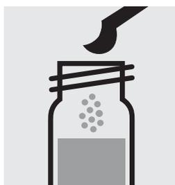
Ajouter 2 microcuillers vertes arsées **AOX-6**, fermer le tube avec le bouchon fileté et mélanger.
