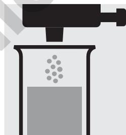
Ajouter 1 dose de **Fe-3** avec le capuchon doseur bleu. Agiter vigoureusement le tube pour dissoudre la substance solide.
