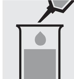
Pipetter 0,50 ml de H<sub>2</sub>O<sub>2</sub>-1 dans une éprouvette.
