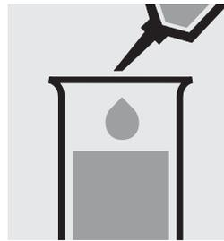
Pipetter 1,0 ml d'échantillon dans une éprouvette.
