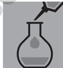
Compléter le ballon jaugé avec d'éthanol, jusqu'au trait de jauge, en opérant à **l'abri de la lumière!**
