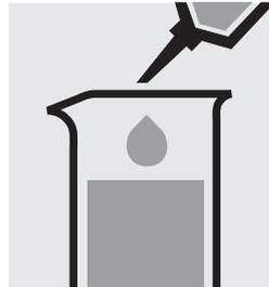
Ajouter 1 ml de l'**acide chlorhydrique 1 mol/l pour analyses** à la pipette et mélanger.
