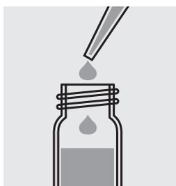
Pipeter 0,5 ml d'échantillon dans un tube de réaction.
