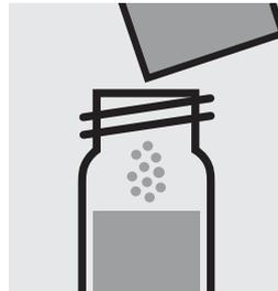
Ajouter 1 sachet de poudre de **Molybdeneum HR2**, fermer avec le bouchon fileté et dissoudre la substance solide.
