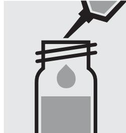
Pipetter 0,10 ml l'échantillon dans un tube à essai, fermer avec le bouchon fileté et mélanger.
