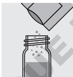
Ajouter le contenu d'un sachet de poudre de **VARIO Silica HR Citric Acid F25** et fermer le tube avec le couvercle fileté.
