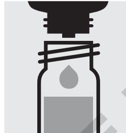
Ajouter 3 gouttes de **CN-2**, fermer avec le bouchon fileté et mélanger: **échantillon préparé**.
