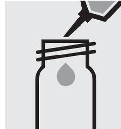
Pipetter 5,0 ml de l'échantillon dilué à 1:500 dans un tube vide (tubes vides, art. 250621).
