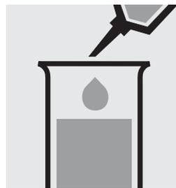
Pipetter 4,0 ml d'échantillon dans une éprouvette.
