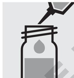
Pipetter 1,0 ml d'échantillon dans un tube à essai et mélanger.
