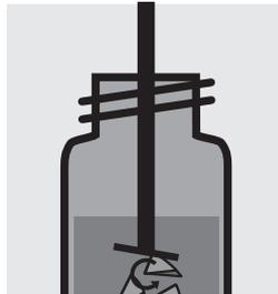
Broyer le filtre à l'aide d'un homogénéisateur
