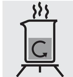
Evaporer presque jusqu'à dessiccation dans un bécher sur une plaque chauffante 200 ml de solution à analyser.
