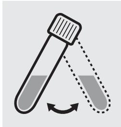
En agitant, mettre le sédiment en suspension dans le tube.
