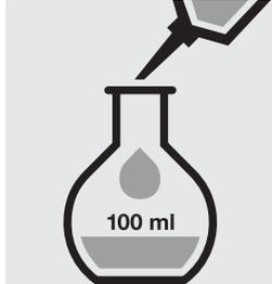
Pipetter 25 ml d'échantillon dans un ballon jaugé de 100 ml, remplir d'eau distillée jusqu'au trait et bien mélanger.
