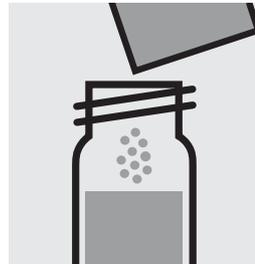
Ajouter 1 sachet de poudre de **Molybdeneum HR1**, fermer avec le bouchon fileté et dissoudre la substance solide.
