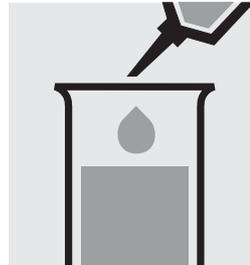
Pipetter 5,0 ml d'échantillon dans une éprouvette.
