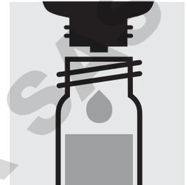
Ajouter 2 gouttes de **réactif 1**, fermer avec le bouchon fileté et mélanger.
