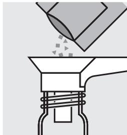
Ajouter le contenu d'un sachet de poudre de **VARIO Potassium Persulfate F10** et fermer le tube avec le couvercle fileté.
