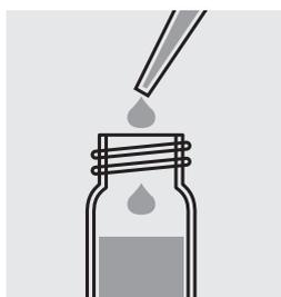
Ajouter avec une pipette 0,5 ml de solution de réactif **VARIO Hydra2 Reagent Solution** et fermer le tube avec un bouchon fileté.
