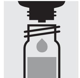
Ajouter 15 gouttes de **B-5**, fermer avec le bouchon fileté et mélanger.
