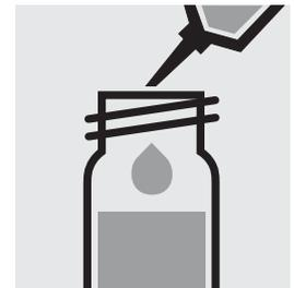
Ajouter 5,0 ml de **toluol pour analyses** à la pipette. Fermer avec le bouchon fileté.
