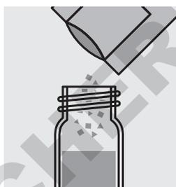
Ajouter le contenu d'un sachet de poudre de **VARIO Silica HR Acid Rgt F10** et fermer le tube avec le couvercle fileté.
