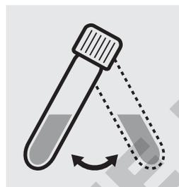
Agiter légèrement le tube avant la mesure.
