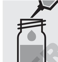
Ajouter 5,0 ml d'échantillon à la pipette, fermer avec le bouchon fileté et mélanger.
