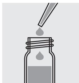
Pipeter 5 ml d'échantillon dans un tube de réaction et fermer le tube au moyen du couvercle fileté.
