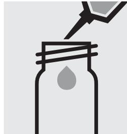
Pipetter 5,0 ml d'échantillon dans un tube.
