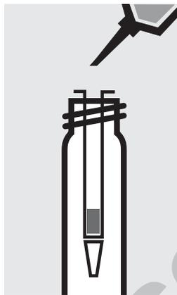
Faire couler à 3 reprises 1 ml à chaque fois de réactif **AOX-3** au travers de la colonne. Jeter la solution de lavage.
