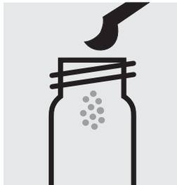
Verser 1 microcuiller bleue arasée de **NO<sub>3</sub>-1** dans un tube vide (tubes vides, art. 250621) et sèche.
