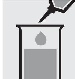
Pipetter 8,0 ml d'échantillon dans une éprouvette.
