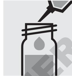
Ajouter 10 ml d'échantillon à la pipette, fermer avec le bouchon fileté et mélanger.
