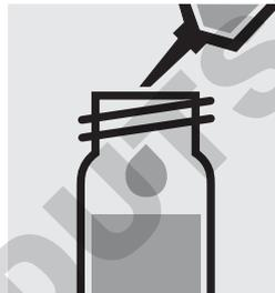
Ajouter 0,80 ml de **B-3** à la pipette, fermer avec le bouchon fileté et mélanger.
