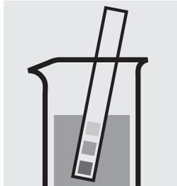
Vérifier le pH de l'échantillon. Domaine nécessaire: pH 2–8
