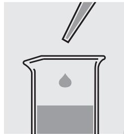
Ajouter 0,5 ml de **VARIO DEHA 2 RGT** avec une pipette et mélanger.
