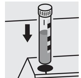
Placer le tube dans le compartiment, faire coïncider le trait du tube sur celui du photomètre.
