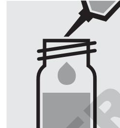
Pipetter 10 ml d'eau distillée dans un deuxième tube à essai, fermer avec le bouchon fileté et mélanger. (blanc)
