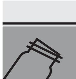
Remplir entièrement sans bulles d'air (!) un tube à essai avec de l'eau à doser.
