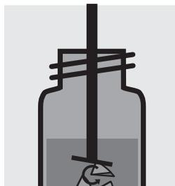
Broyer le filtre à l'aide d'un homogénéisateur
