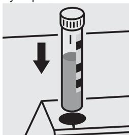
Placer le tube dans le compartiment, faire coïncider le trait du tube sur celui du photomètre.
