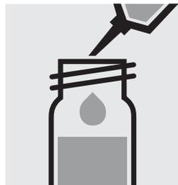
Ajouter 1,0 ml de  **$\text{NO}_3\text{-1K}$**  à la pipette, fermer avec le bouchon fileté et mélanger. **Attention, le tube devient brûlant.**
