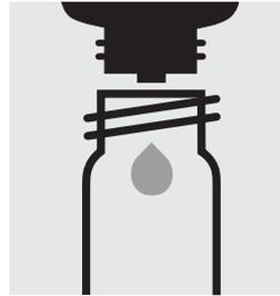
Verser 6 gouttes de Cl<sub>2</sub>-1 dans un tube.
