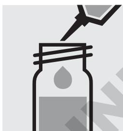
Pipetter 0,20 ml de **AOX-1K** dans un tube à essai et mélanger.
