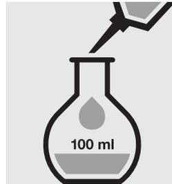
Pipetter 4,0 ml d'échantillon dilué dans un ballon jaugé de 100 ml, remplir d'eau distillée jusqu'au trait et bien mélanger.
