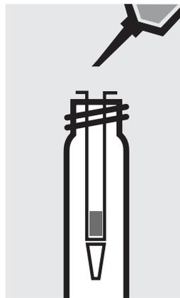
Faire couler à 3 reprises 1 ml à chaque fois de réactif **AOX-2** au travers de la colonne. Jeter la solution de lavage.
