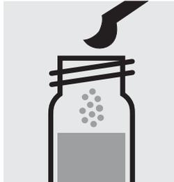
Verser 1 microcuiller jaune arasée de NO<sub>3</sub>-1K dans un tube à essai, fermer avec le bouchon fileté.
