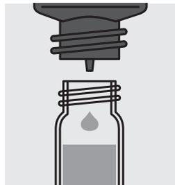
Ajouter 4 gouttes de **Mn-3**, fermer le tube au moyen du couvercle fileté et mélanger.
