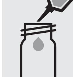
Pipetter 5,0 ml de l'échantillon dilué à 1:4 dans un tube vide (tubes vides, art. 250621).
