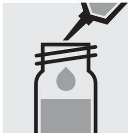
Pipetter **prudemment** 3,0 ml d'échantillon dans un tube à essai, fermer hermétiquement avec le bouchon fileté et mélanger vigoureusement. **Attention, le tube devient brûlant.**
