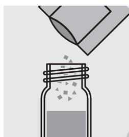
Ajouter le contenu d'un sachet de poudre de **Chlorine Free-DPD F10** et fermer le tube avec le couvercle fileté.
