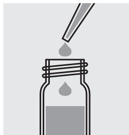
Avec une pipette, ajouter 0,5 ml d'échantillon, fermer le tube avec le couvercle fileté et mélanger vigoureusement pendant au moins 30 s. Il se peut, éventuellement, qu'une petite quantité de matière solide ne soit pas dissoute.
