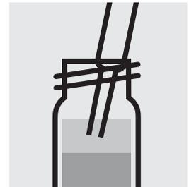
A l'aide d'une pipette Pasteur, aspirer la couche claire supérieure colorée et dessécher sur **sulfate de sodium anhydre pour analyses**.
