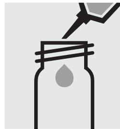
Pipetter 5,0 ml d'échantillon dans un tube.
