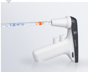
Position de repos avec pipette enfilée
