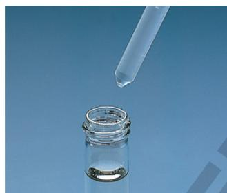
Les milieux à haute pression de vapeur allant jusqu'à 500 mbar, comme les alcools, les éthers et les hydrocarbures, seront également dosés avec la plus grande des précisions de façon simple et fiable.
