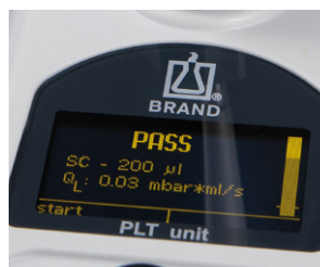
Affiche en quelques secondes seulement le résultat et la divergence avec la valeur seuil
