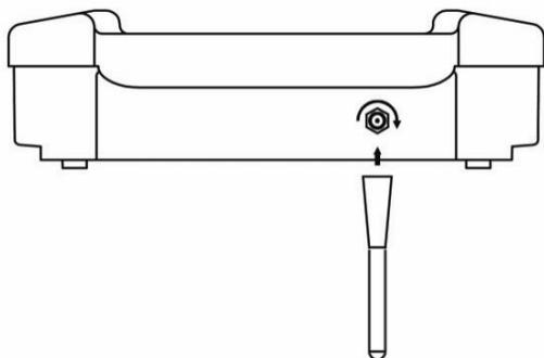
➤ Schrauben Sie die mitgelieferte Antenne auf die Anschlussbuchse auf der Oberseite der Basisstation.
