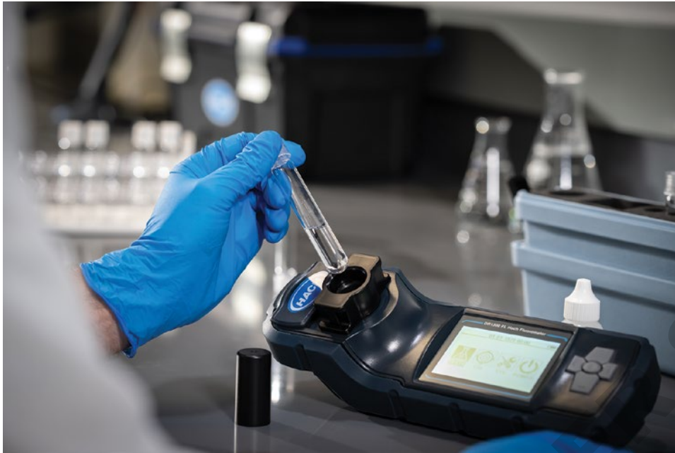
Fluoromètre portatif DR1300 FL
