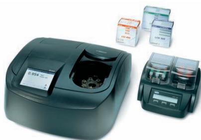
Pour la DCO et de nombreux autres paramètres : spectrophotomètre, tests en cuve, thermostat
