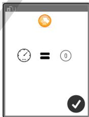
5. Lorsqu'il est confirmé que le système s'est dépressurisé, toucher
