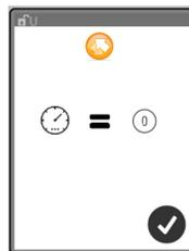
17. Lorsqu'il est confirmé que le système s'est dépressurisé, toucher
