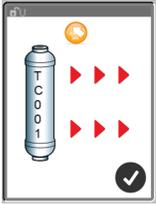
apparaît, soulever le panneau avant gauche et retirer le module de prétraitement **TC001** de ses attaches et débrancher le raccord coudé à chaque extrémité.
