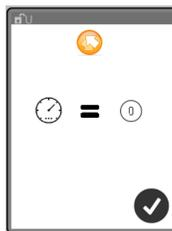
17. Lorsqu'il est confirmé que le système s'est dépressurisé, toucher
