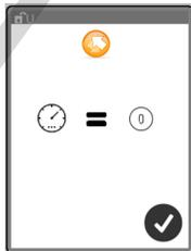
5. Lorsqu'il est confirmé que le système s'est dépressurisé, toucher
