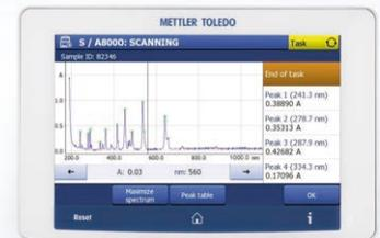
L'interface utilisateur est intuitive et assure une manipulation efficace. L'opérateur bénéficie d'une représentation claire des spectres et des résultats à travers une utilisation intelligente des couleurs et le grand écran tactile. Un simple effleurement du doigt sur l'écran permet d'effectuer un zoom sur les détails des spectres, et ce même avec des gants de protection.
