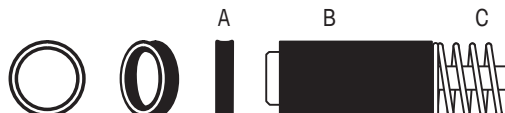
A : Joint (remarque : le bord ouvert est placé face à l'extérieur) B : Dispositif de retenue du joint C : Assemblage du piston
