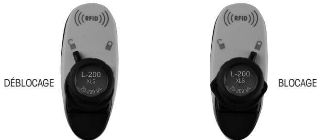
Figure 2 : Commande de blocage du volume
