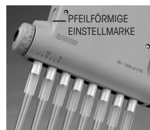
Abbildung 15: Abstandsmarkierungen auf dem Spitzenträger
