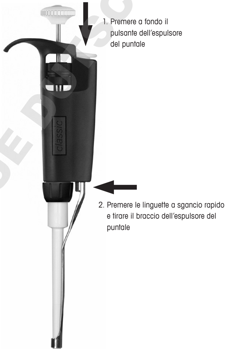
Figura 5: Rimozione del braccio espulsore del puntale
