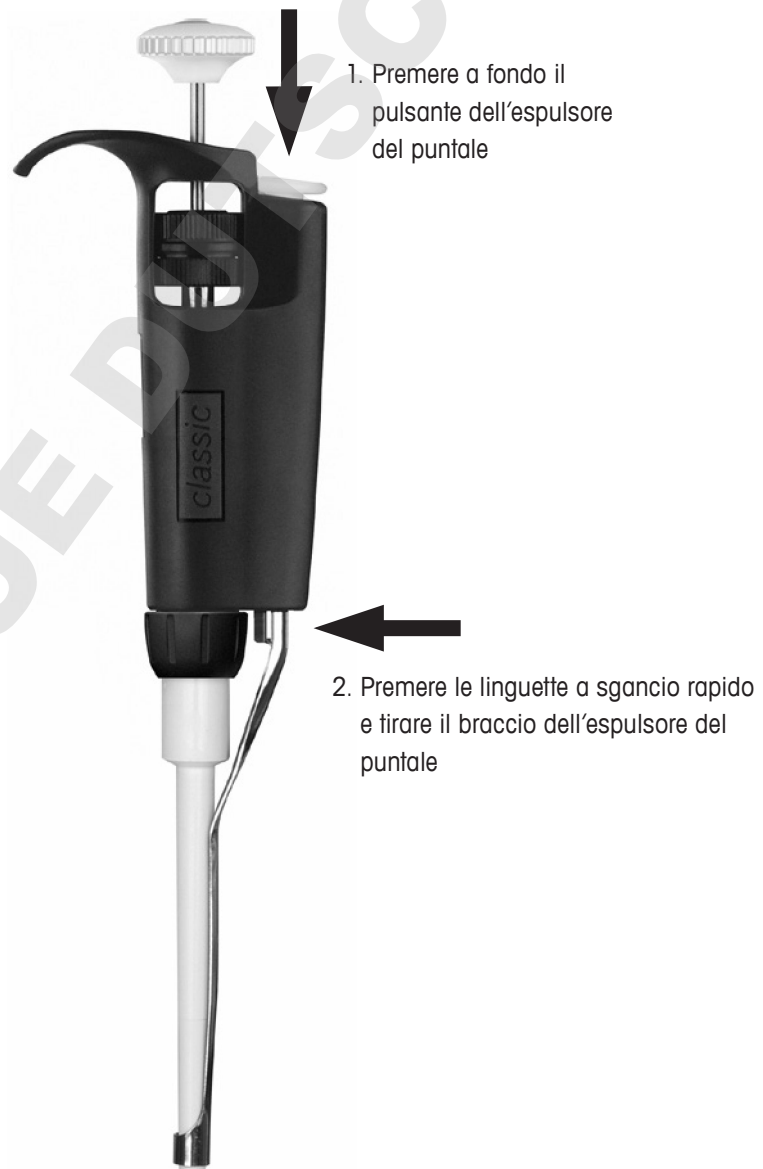
Figura 5: Rimozione del braccio espulsore del puntale
