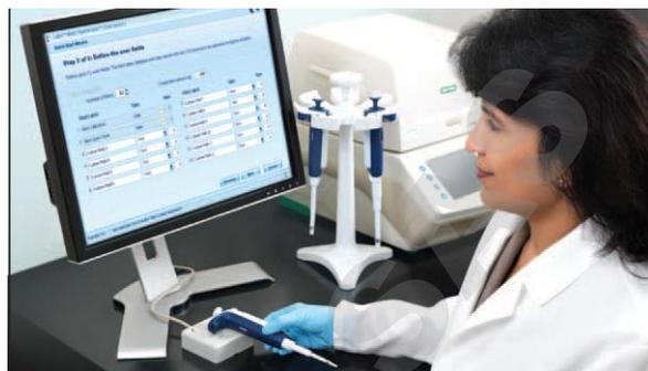
Le lecteur RFID optionnel fonctionne avec toutes les pipettes RFID Rainin et s'interface avec le logiciel LabX™ Direct Pipette-Scan™ de METTLER-TOLEDO pour la vérification d'étalonnage.
